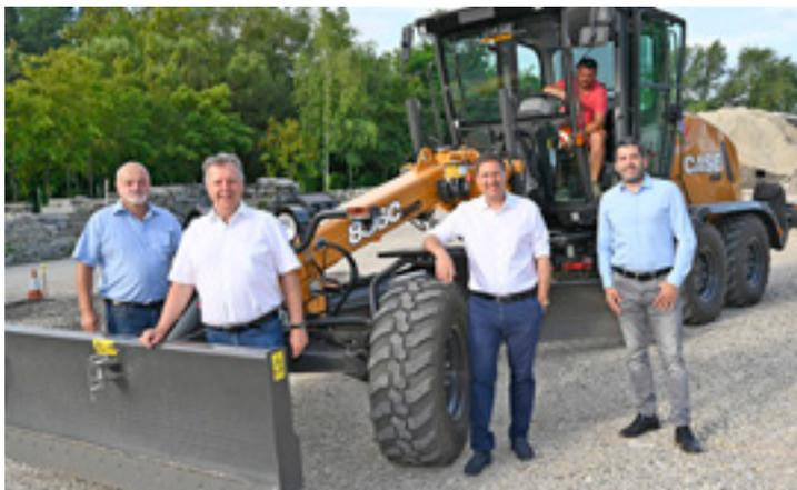
Mit einem neuen **Grader** arbeitet ab sofort die städtische Dienststelle **Tiefbau**. Der CASE 836C 6WD verfügt über einen hydrostatischen Fahrtrieb mit Allrad, einen 156 PS starken Dieselmotor sowie zwei Frontkameras und eine Heckkamera zur Sicherheit im Straßenverkehr. Zum Einsatz kommt das Fahrzeug unter anderem beim **Straßen- und We-**
